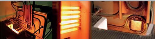
Le test est réalisé avec un flux thermique de 20 kW/m<sup>2</sup>.
