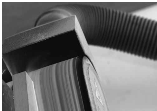
Vang het houtstof direct weg waar het wordt geproduceerd
