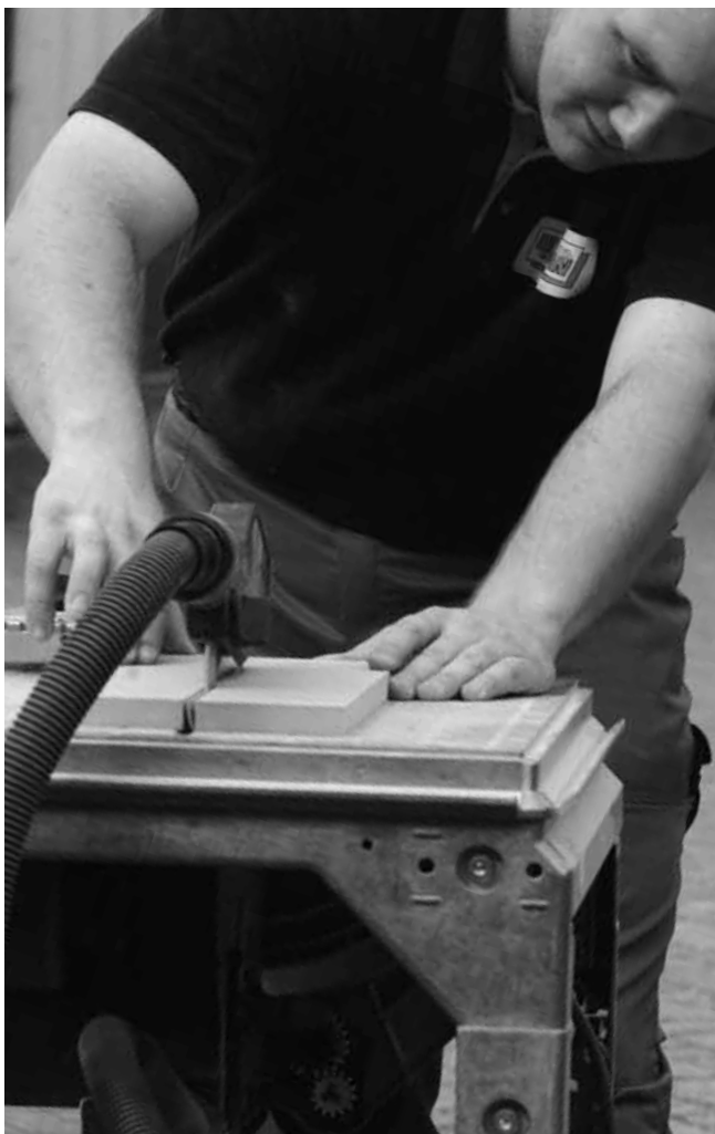
Vast opgestelde machines dienen aan de boven- en de onderzijde te worden afgezogen
