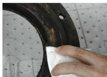
3-Lagen Smeltspin polypropyleen + spinvlies aan beide zijden, gebonden en geperforeerd
